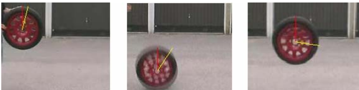
figur 23 - Studsförlopp - 1 utgångsläge, 2 studsögonblick, 3 vändhöjd
