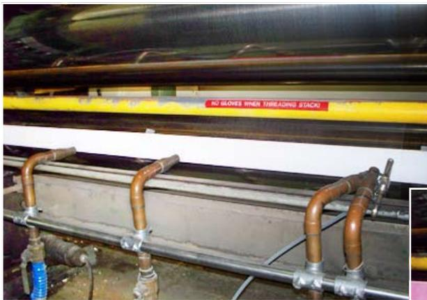
Pressurex wird bei Mohawk Fine Paper auf der Walze platziert, bevor der Walzenspalt geschlossen wird.
